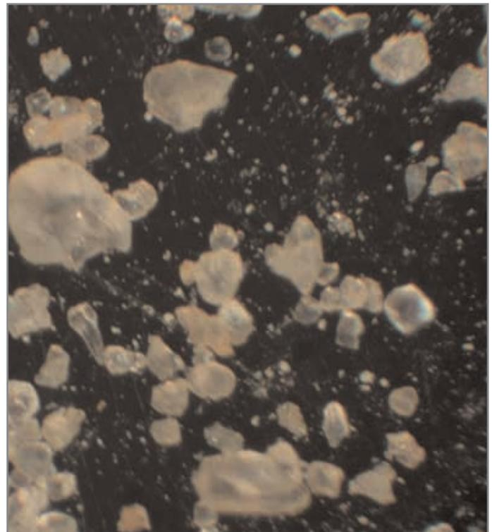
Die hier dargestellten Kalkkristallformen wurden durch die UMH-Wasseraufbereitung zu Aragonit umstrukturiert. Durch die runden Formen der Kalkstrukturen ist keine Tendenz mehr zu festanhaftenden Belägen gegeben. Die sandigen Rückstände werden ausgeschwemmt. Bereits vorhandene Verkrustungen lösen sich allmählich wieder auf.
