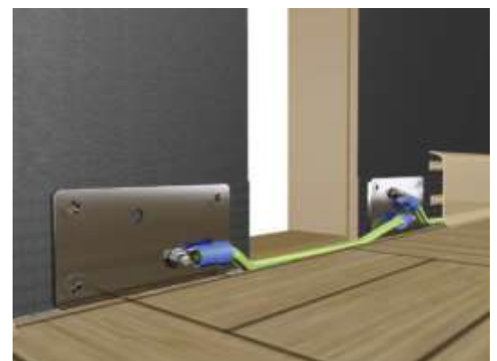
Abb.7 Verbinden von Raumöffnungen mit Bodenklebetechnik oder mit Hilfe von zwei Erdungsplatten.
